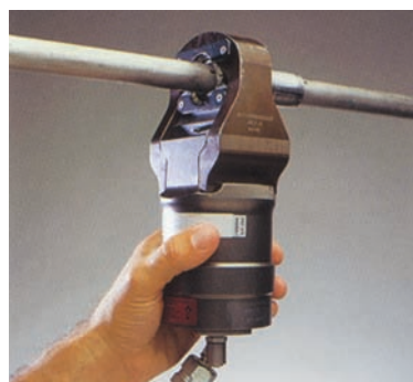
Coloque la herramienta de PYPLOK® alrededor del racor y presurice
