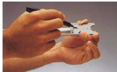
Marque el tubo a través de la ranura del calibre
